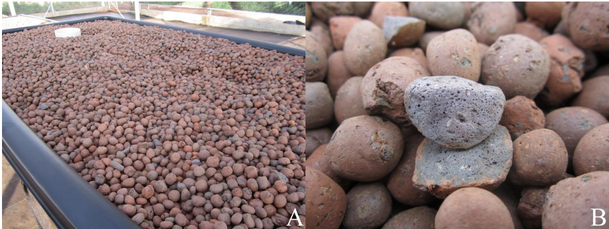
Figura 3: A) Caixa com argila expandida e sem solo; B) Detalhe da porosidade da argila expandida. Fotos: CARDOSO, B.M.V. 2016.
